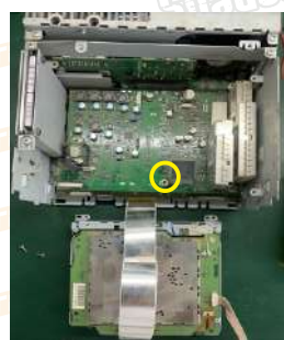
Abrir la tapa superior y retirar el tornillo para insertar la pcb suministrada
